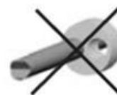
Bild 4 Insatt tätningssats med endast en kabel är inte tillåten!
