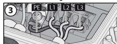
Fig. 2: Anslutning av ledningarna till plintarna
